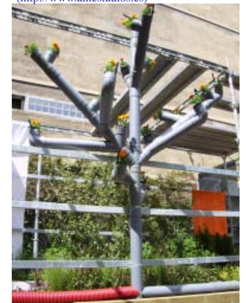
sistema de hidroponía vertical - árbol (tamaño aprox. 3m x 3m) - tubería de 110mm diam pvc.
